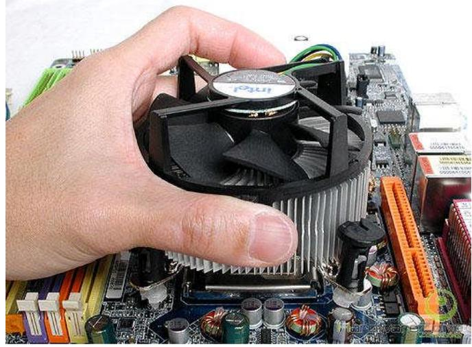
ولكن نلاحظ انه لضمان التبريد الكامل للمعالج فانه لابد من وضع مادة تسمى PROCESSOR HEATER SINK وهى عجينة حرارية من مكونات السيلكون تساعد على تبريد المعالج ة توضع فوق المعالج قبل تركيب ال FAN ومن وظيفتها تبريد المعالج و تقوم العجينة بامتصاص الحرارة من المعالج و جعلة باردا بقدر المستطاع
