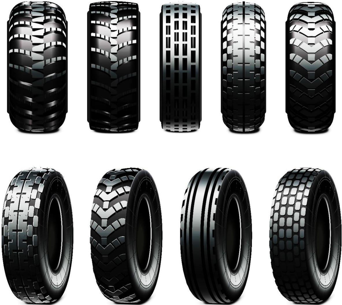
الشكل (14.2) : عجلات مطاطية متنوعة تعمل بالهواء المضغوط لرافعة شوكية .
