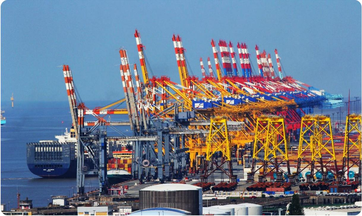
الشكل (3.5) : روافع الرصيف الكهربائية .
