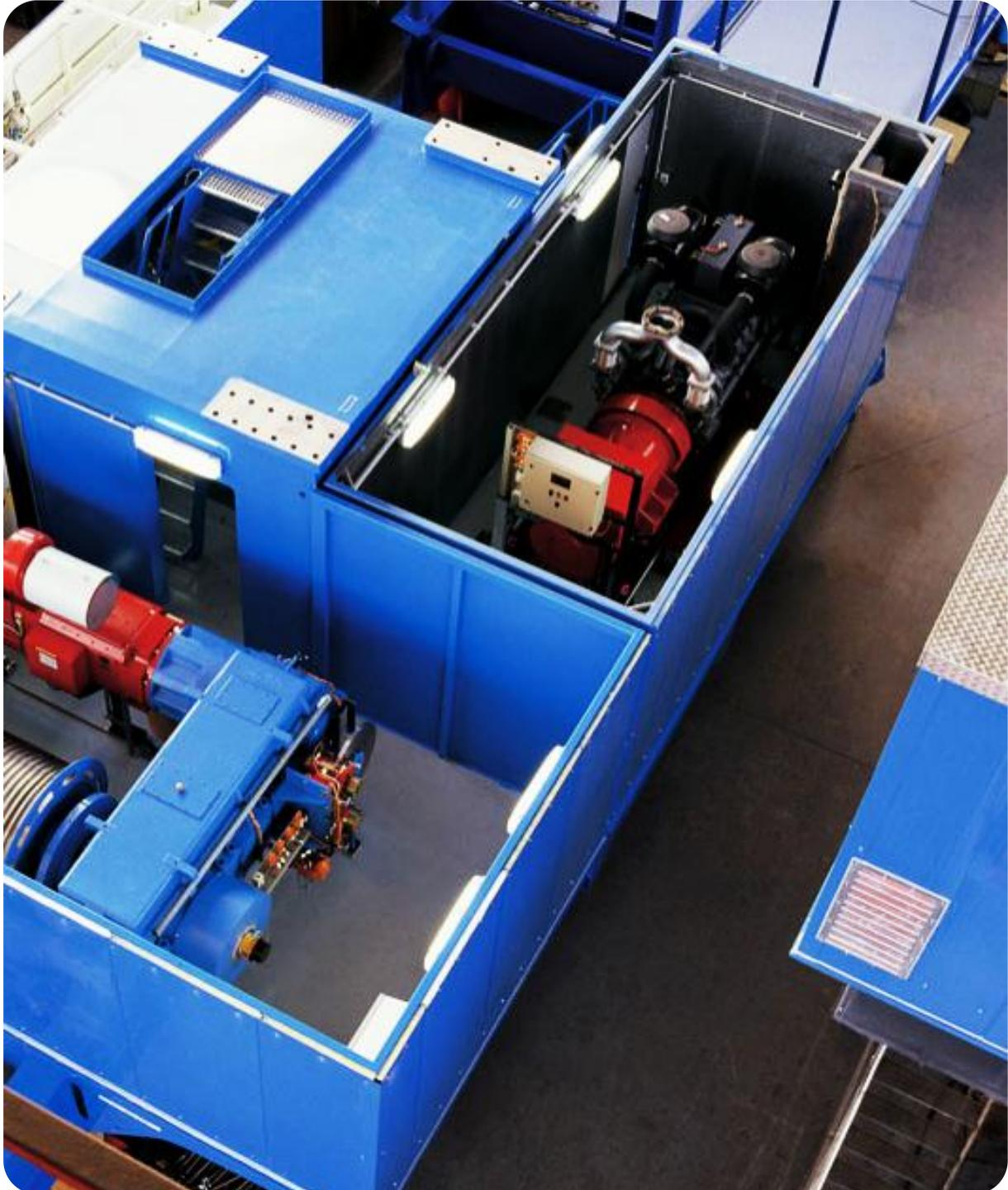
الشكل (30.4) : غرفة الآليات التي تتوضع فيها معظم تجهيزات المنظومة الهيدروليكية .
