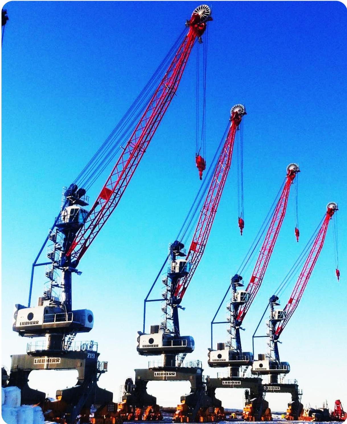
الشكل (4.5) : مجموعة من روافع الرصيف الكهربائية البرجية .
