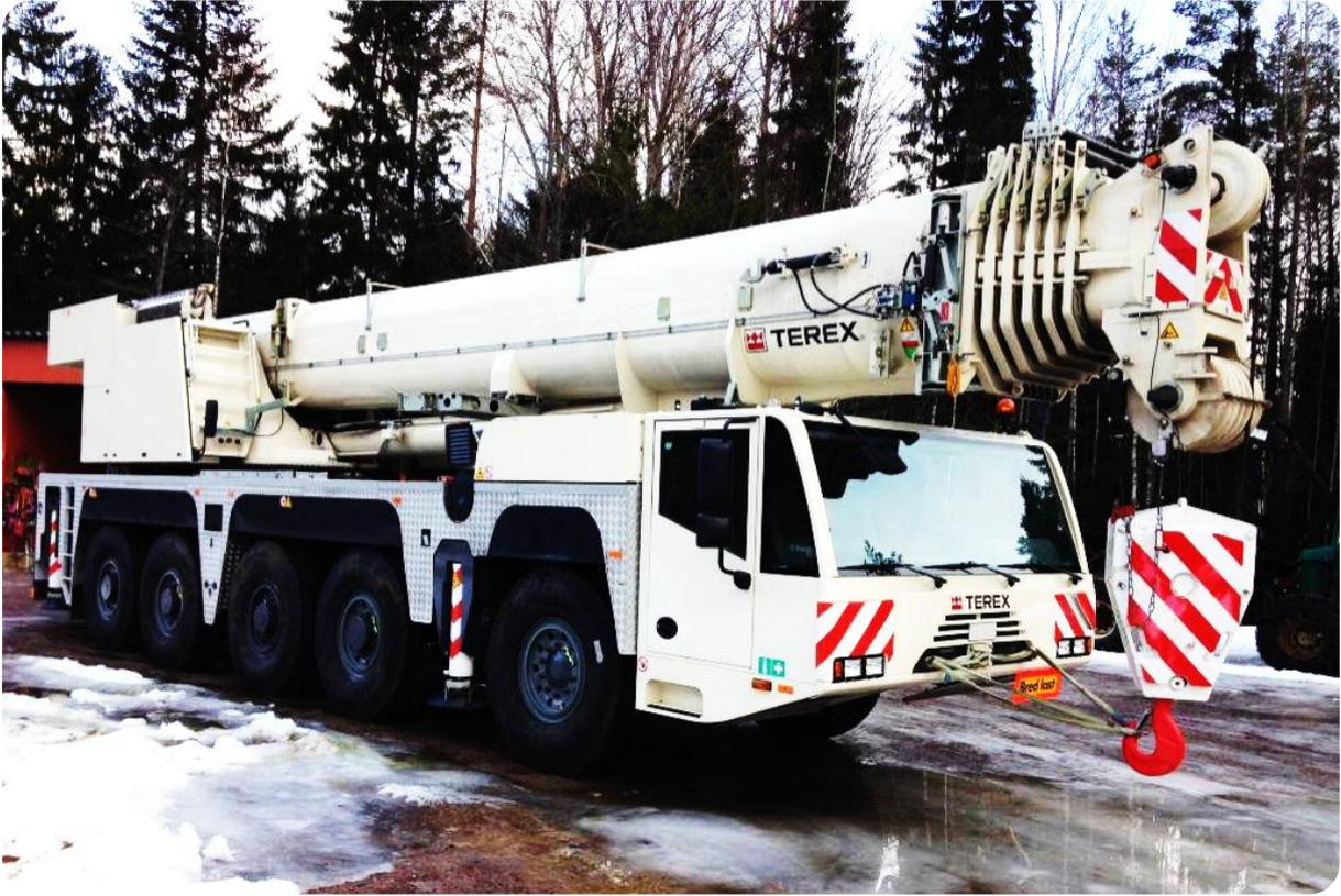
الشكل (1.3) : الرافعة التليسكوبية Terex Demag بقدرة تحميلية 40 طن .
