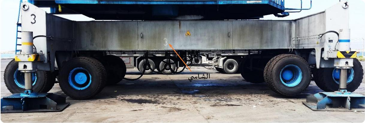
الشكل (9.4) : الهيكل الفولاذي للشاسي .
