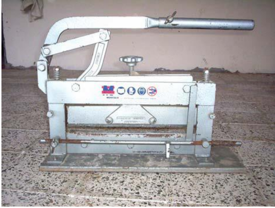
١٨ - ماكينة قص سيراميك يدوي: تستخدم في قص بلاط السيراميك في خطوط مستقيمة ويمكن تحديد مقاسات ثابتة لأكثر من بلاطة دون تكرار القياس ووضع العلامات.
