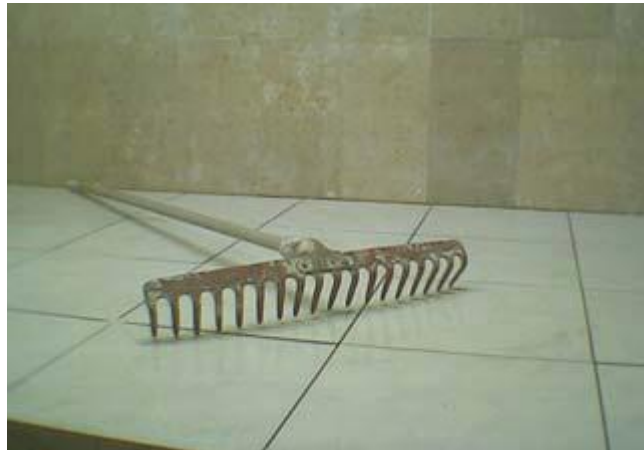
٢٢- شوكة : تستخدم لفرد طبقة الرمل أسفل البلاط قبل التركيب.
