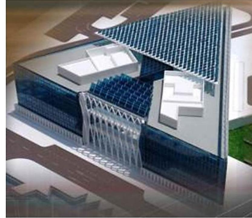
استخدام الخلايا الكهروضوئية فوق سطح المبنى
