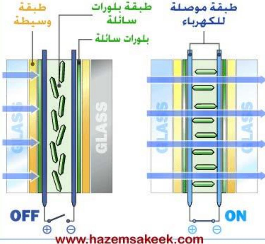
عمل البلورات السائلة في النوافذ الذكية على التحكم في كمية الضوء النافذ منها وذلك من خلال تغيير إستجابة البلورات السائلة للشحنات الكهربائية. حيث تعمل الشحنة الكهربائية على ترتيب البلورات بشكل منتظم لتسمح للضوء بالمرور وعندما تختفي الشحنة الكهربائية تعود البلورات إلى وضعها العشوائي مما يمنع أشعة الضوء بالمرور خلالها.
