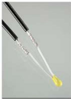
٤- المقاومة الضوئية : Photoresistor
