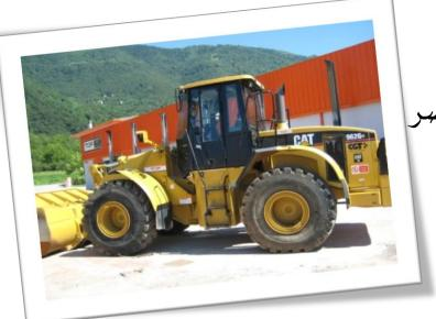
\*التركسات (الغرافة): هي معدة هندسية ذو فئات متعددة ينحصر عملها في تحريك التربة بمختلف أنواعها (من حفر وتعبئة وتفريغ)
