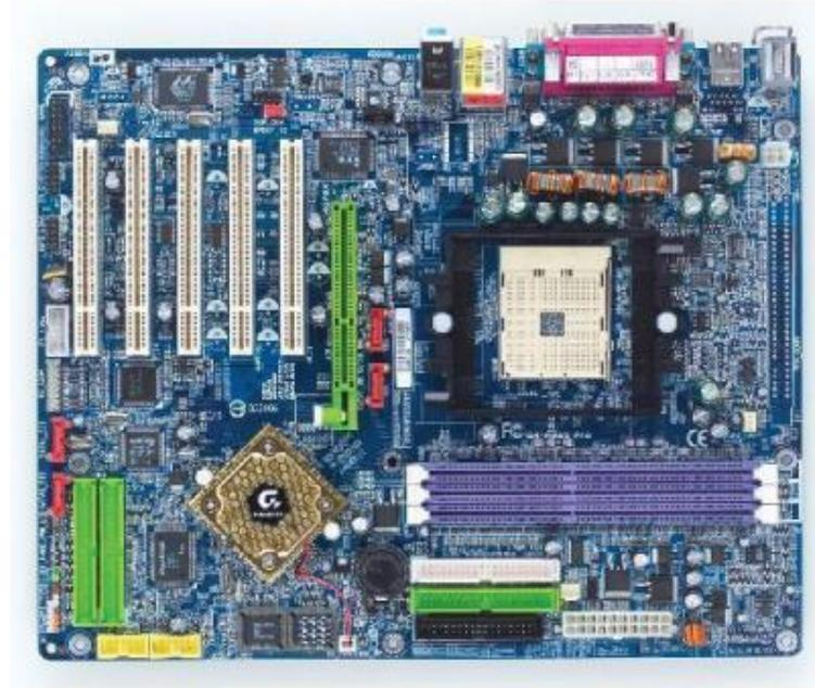
اللوحة الام تعتبر الاساس وذلك لانها تحمل بقيه المكونات وتقوم بتمرير البيانات بينها عن طريق ما يسمى **Data Buses** كما انها تحتوى على شقوق توسعه **Expansion Slots** فى حاله اذا رغبت فى رفع امكانيات الجهاز عن طريق اضافات قطع اضافيه مثل كارت التليفزيون
